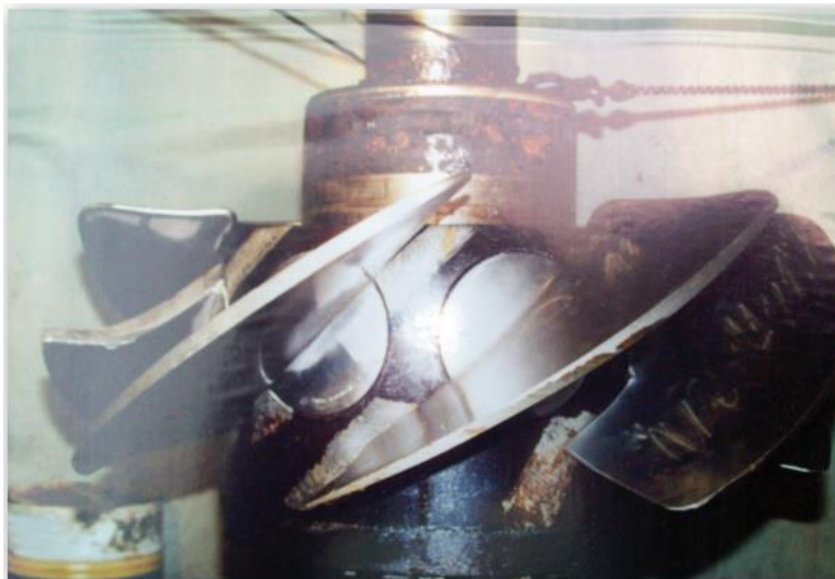
Vista superior del rodete de la turbina tipo Kaplan de la central Los Molinos II, en proceso de extracción por la rotura de uno de sus álabes.
