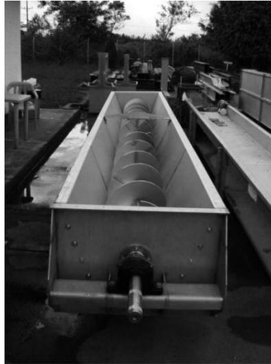
*Ilustración 18. Transportador de tornillo*
