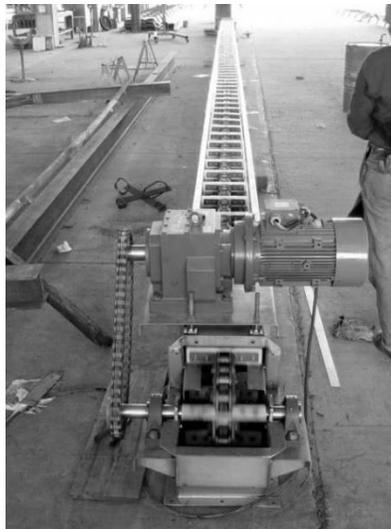
*Ilustración 19. Transportador de cadena*
