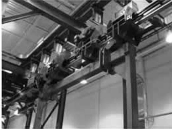
*Ilustración 21. Transportador teleférico o Trole*
