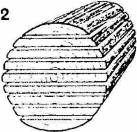
2. Despiezo común, en plano, en plancha o a hilos paralelos
