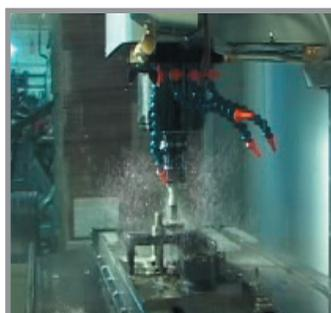
Fig. 6 - Formación de niebla al aplicar el fluido de corte.
