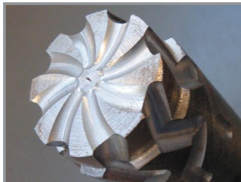
Fig. 2 - Ejemplo de pieza producida por operaciones de torneado y fresado
