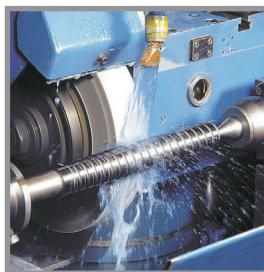
Fig. 4 - Utilización de fluido de corte
