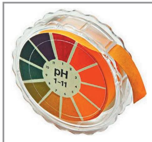
Fig. 12 - Cinta de medición de PH
