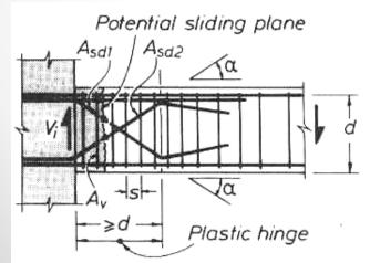
Control de Deslizamiento por corte en una zona potencial plástica de una viga.
