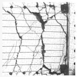
Mecanismo de Reticulado. Grandes desplazamientos de corte a lo largo de fisuras de flexión a través de una zona de rótula plástica de una viga.
