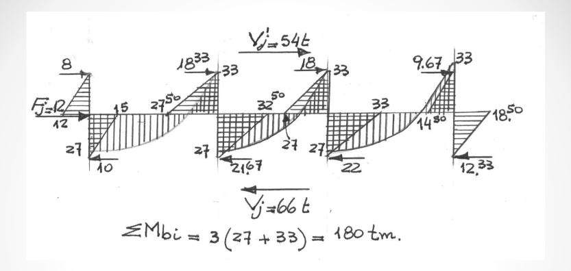
El IC-103 establece que en cualquier tramo de una viga continua en un pórtico dúctil los máximos momentos absolutos se pueden disminuir hasta un máximo del 30 % del máximo momento derivado para ese tramo del análisis elástico, para cualquier combinación que incluya el sismo y cargas gravitatorias.
