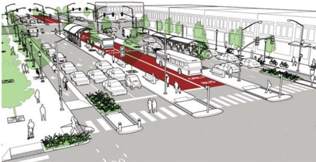
Fig. 38: separación modos de transporte: peatón, bicicleta, vehículo particular, bus por carril exclusivo central
