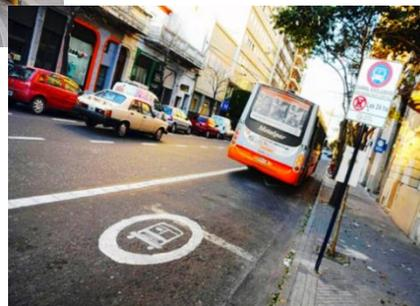
Derecho de vía tipo B: ***existe una separación física longitudinal a través de elementos fijos, tales como barreras o guarniciones. Se mantienen los cruces a nivel con otros vehículos así como con los peatones.*** Caso de vialidades dedicadas al transporte público en Curitiba, Bogotá (Transmilenio). BRT (Bus Rapid Transit)
