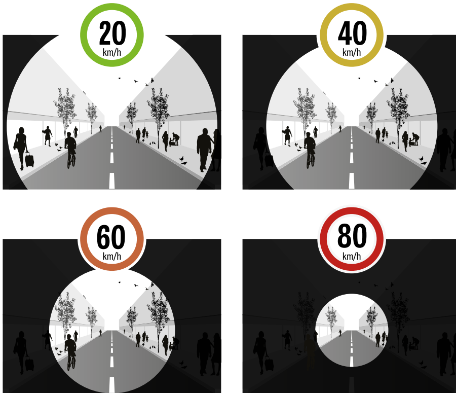
Relación entre velocidad y "campo visual". Basado en diagrama de Hirschberger, & Miedel 1980 (Bartmann 1991).
