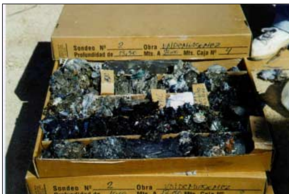
FOTO VI.3 Composición de los RSU en el sondeo S2 – profundidad 13 – 20 m
