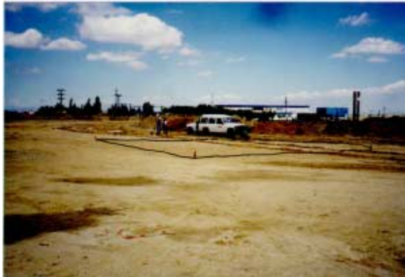
FOTO IV.4 - Bucle emisor (tx) empleado en los sondeos electromagnéticos transitorios
