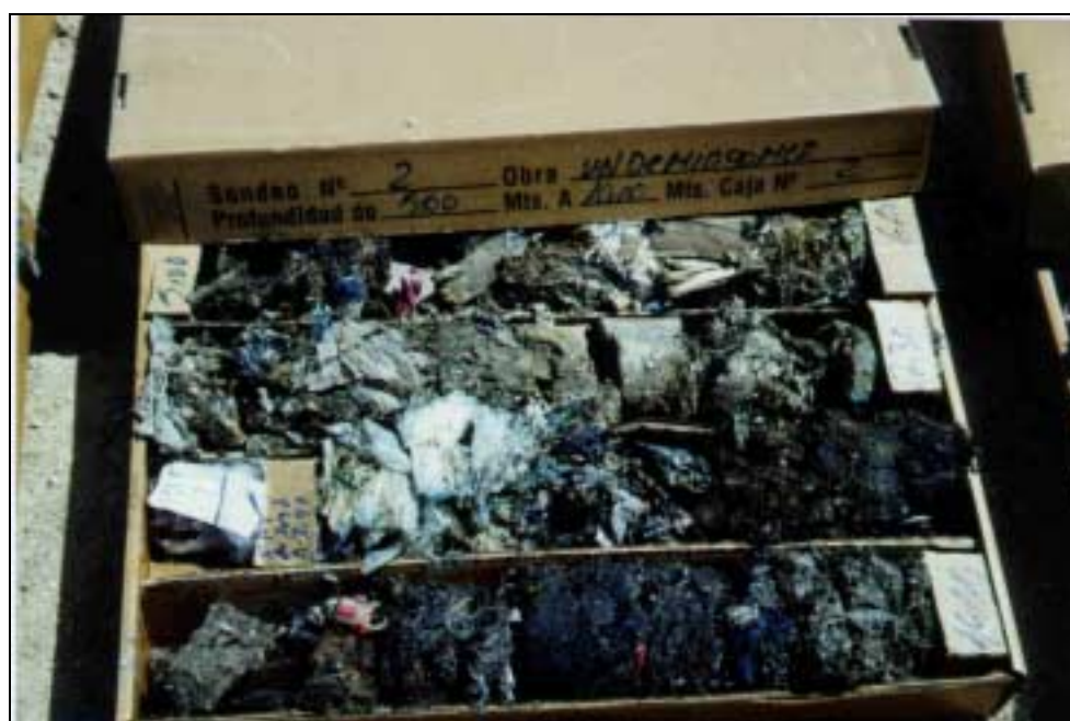
FOTO VI.2 Composición de los RSU en el sondeo S2 – profundidad 0 – 13 m
