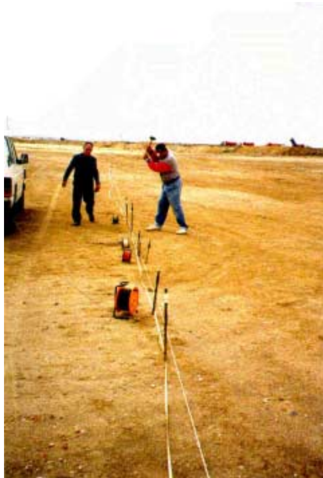
FOTO IV.6 – Disposición de los electrodos para la realización de la calicata eléctrica
