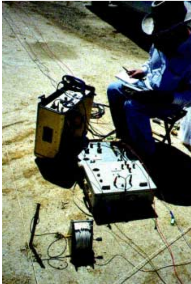
FOTO IV.7 - Resistivímetro desarrollado en el CEF para la realización de ensayos eléctricos
