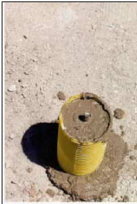
FOTO V.3 - Detalle del punto de referencia
