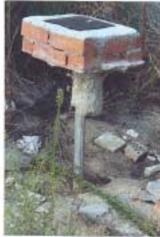
FOTO VII.2 – Situación de la caja de lectura a medida que se incrementaban los asientos.
