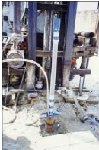
FOTO V.7 - Montaje del micrómetro deslizante
