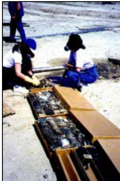
FOTO VI.1 – Observación de la composición de los residuos en las cajas-testigo de sondeo
