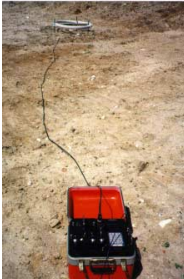
FOTO IV.5 - Antena receptora (rx) y receptor empleado en los sondeos electromagnéticos transitorios
