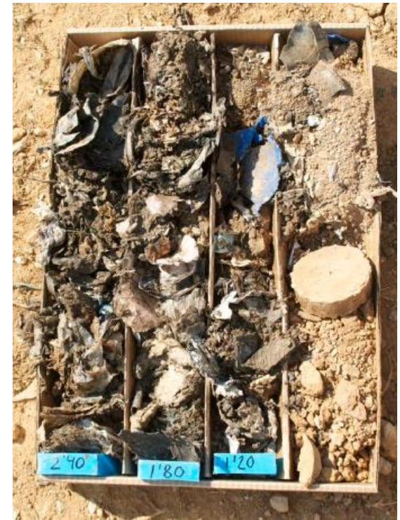
Caja de testigos de RSU
