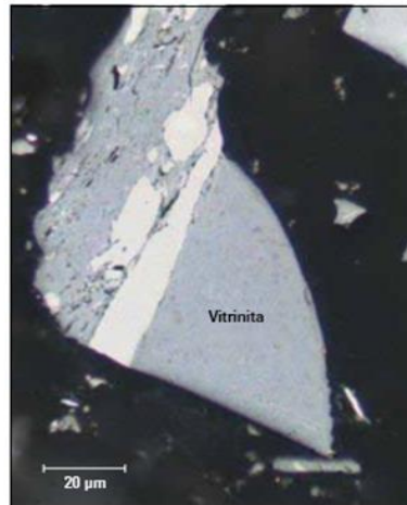
Figura 8. La vitrinita en el carbón bituminoso. La cantidad de luz reflejada por los macerales de la vitrinita constituye una prueba clave para determinar la madurez térmica de una roca.
