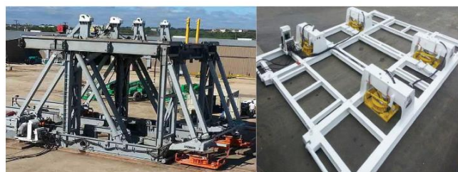
Figura 4. Equipo móvil con piernas laterales (izquierda) y base con pies para la sub estructura (Derecha) (ENTRO, 2014).
