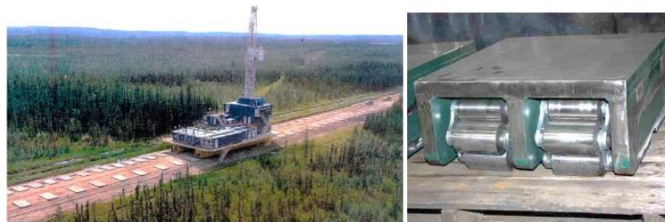
Figura 3. Movilización de un equipo de perforación mediante un sistema deslizante (ENTRO, 2014)
