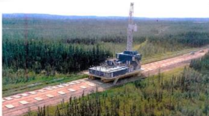
Movilización de un equipo de perforación mediante un sistema deslizante
