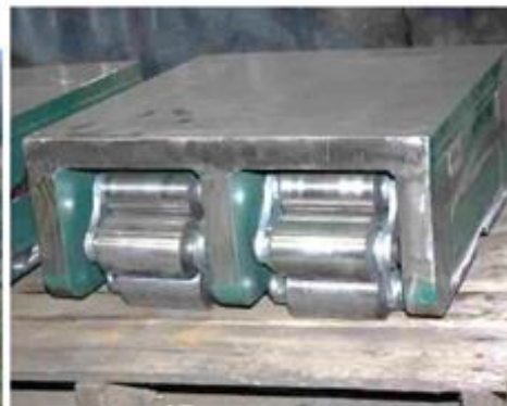
Movilización de un equipo de perforación mediante un sistema deslizante
