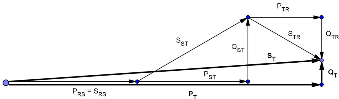
7.- Una carga en estrella con  $Z_R = 6/0^\circ$ ,  $Z_S = 6/30^\circ$  y  $Z_T = 5/45^\circ$ , se conecta a un sistema trifásico tetrafilar, 208 V y secuencia TSR. Determinar: a) las intensidades de corriente en las líneas, incluido el neutro, suponiendo positivo el sentido hacia la carga. b) las potencias parciales y total; c) dibuje los triángulos de potencias parciales y el total. Considere  $U_R/-90^\circ$ .
