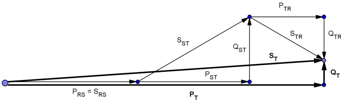
7.- Una carga en estrella con  $Z_R = 6\angle 0^\circ$ ,  $Z_S = 6\angle 30^\circ$  y  $Z_T = 5\angle 45^\circ$ , se conecta a un sistema trifásico tetrafilar, 208 V y secuencia TSR. Determinar: a) las intensidades de corriente en las líneas, incluido el neutro, suponiendo positivo el sentido hacia la carga. b) las potencias parciales y total; c) dibuje los triángulos de potencias parciales y el total. Considere  $U_R/-90^\circ$ .
