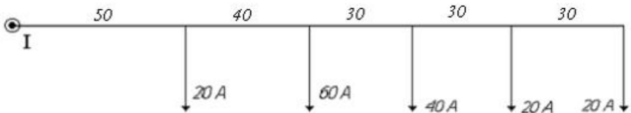
2.- En la línea subterránea bipolar representada en la Figura,  $U = 220$  V de cc.. Como caída de tensión puede admitirse un 2,5 %. Los receptores son lámparas de unos 55 W de consumo por término medio. ¿Qué secciones habrá que dar a la línea en el caso de ser de cobre y de aluminio, respectivamente? Suponer temperatura del terreno de 35 °C. En la zanja se colocarán dos conductores bipolares más además del calculado, siendo el tipo de terreno arena seca.
