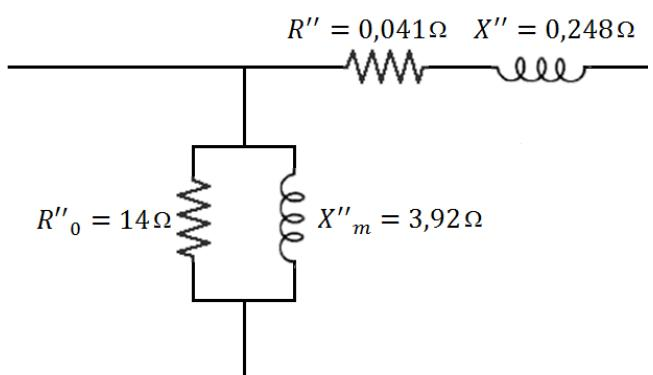
8.-Un transformador a 60 Hz, que tiene 480 vueltas en el devanado primario absorbe una potencia de 80 W y 1,4 A de corriente a un voltaje de entrada en vacío de 120 V. Si la
