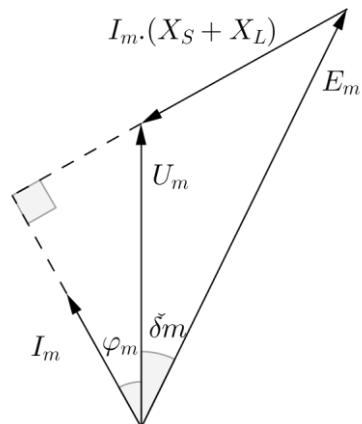
**8.-**Un alternador trifásico tiene una impedancia síncrona  $Z_s = 0+j5 \Omega$  y está conectado a una red de potencia infinita de 6600 V. La excitación es tal que la fem inducida en vacío es de 6000 V. Determinar la potencia activa máxima que en estas condiciones podrá suministrar la máquina, sin que exista pérdida de estabilidad. Hallar también la corriente de inducido y el factor de potencia para dicha carga.
