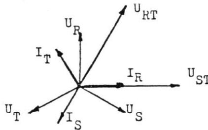
Para el tipo de carga considerada la potencia total será:  $P = W_1 + (-W_2) = 0$ . En general, cuando uno de los vatímetros (en este caso el 2), tiende a señalar en sentido contrario (lo que ocurre para  $\varphi > 60^\circ$ ), se invierte la conexión de uno de sus circuitos y la potencia total se obtiene por diferencia:
