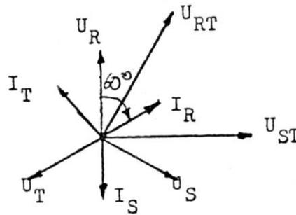
d- Carga  $Z_R = Z_S = Z_T = j X$ ;  $\varphi = 90^\circ$
