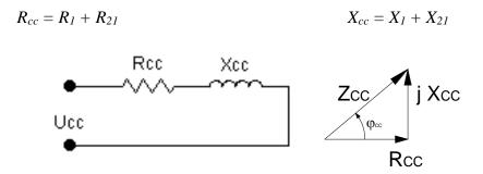
En la mayor parte de los transformadores, por construcción, resulta:
