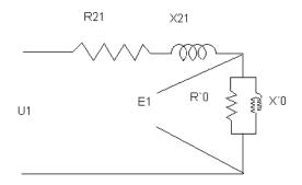
Con los valores medidos y calculados en el ensayo de vacío y en éste, el de cortocircuito, se pueden calcular los siguientes parámetros del transformador para un estado de carga nominal y con un f.d.p. cualquiera, por ejemplo 0,8 que es el clásico.
