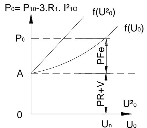
Por lo cual dicha ordenada del eje vertical corresponde a las pérdidas  $P_{R+V}$  que se considera constante durante todo el funcionamiento del motor. Luego para la tensión nominal  $U_n$  la ordenada en la curva resulta la suma  $P_{R+V} + P_{Fe1}$  y por diferencia con  $P_{R+V}$  se puede obtener las  $P_{Fe1}$ .
