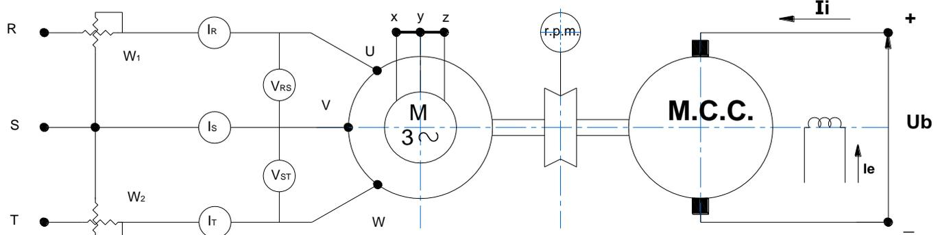
Montaje experimental para el ensayo de vacío
