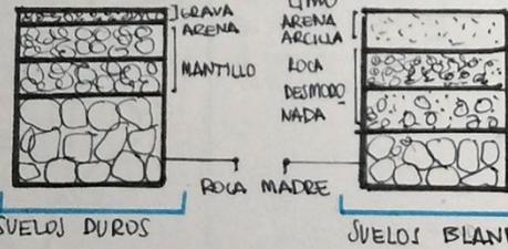
LA GRANULOMETRÍA VA A DETERMINAR LA RESISTENCIA Y ASÍ PODER SABER LAS FUNDACIONES A COLOCAR AL EDIFICIO PARA QUE ESTE ESTABLE Y TRANSMITA LAS TENSIONES AL SUELO.
