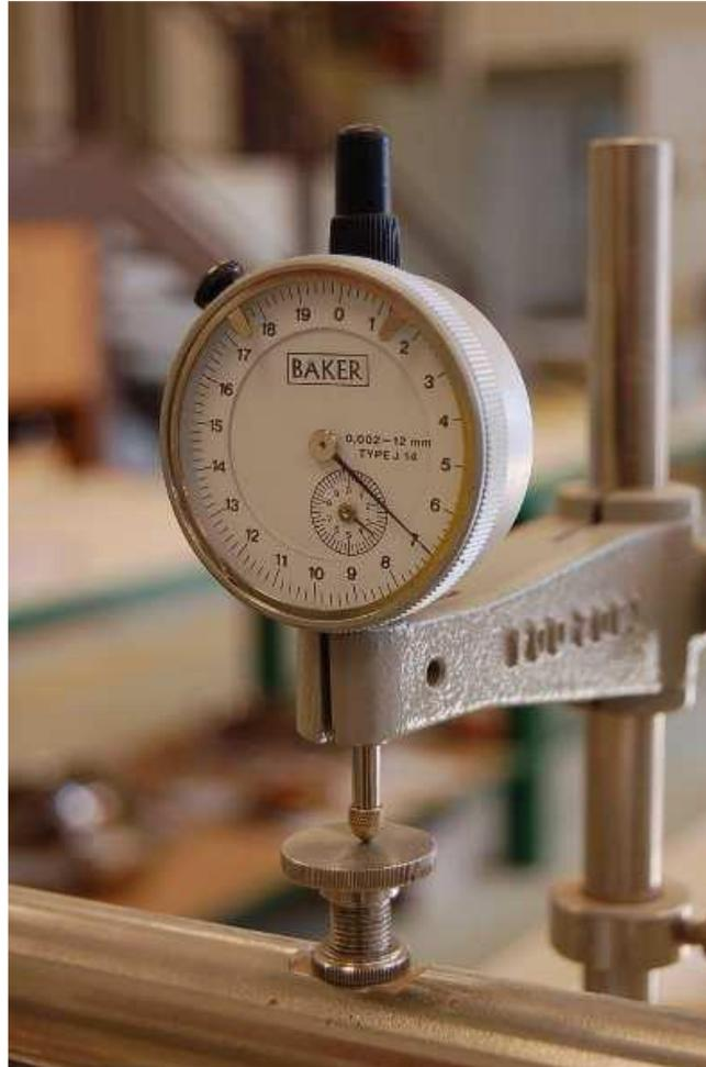
Instrumento para medición del desplazamiento vertical
