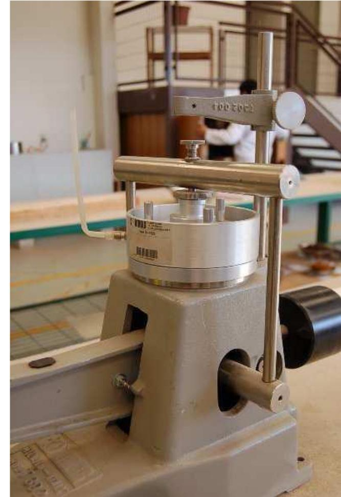
Marco y palanca de aplicación de la carga vertical
