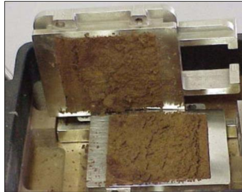
Ensayo de corte directo (relación del esbeltez \ll 1 )
