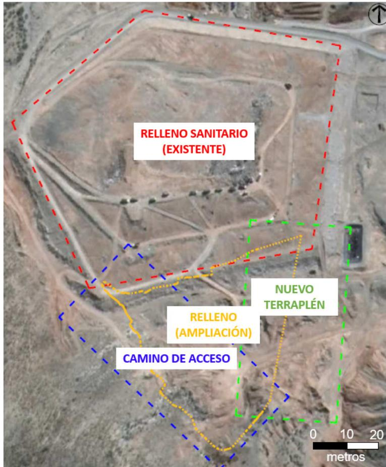
**Figura 2.** Foto satelital del emplazamiento del relleno con detalle de la zona de ampliación
