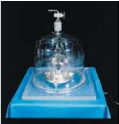
1.4 El objeto de metal encerrado cuidadosamente dentro de estos envases de cristal es el kilogramo estándar internacional.
