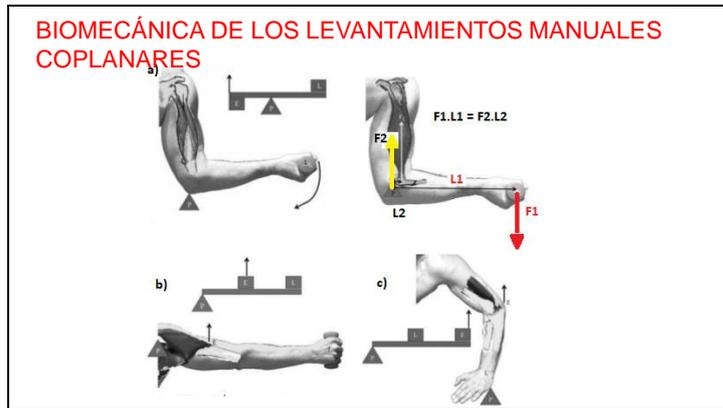
El estudio biomecánico del brazo y antebrazo permite explicar la condición de trabajo más favorable de este sistema (condición a, equivalente a un sistema de palanca con apoyo intermedio)
