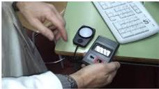
En el puesto de trabajo se debe realizar al menos una medición en cada plano de trabajo, colocando el luxómetro tan cerca como sea posible del plano de trabajo, y tomando precauciones para no proyectar sombras ni reflejar luz adicional sobre el luxómetro.
