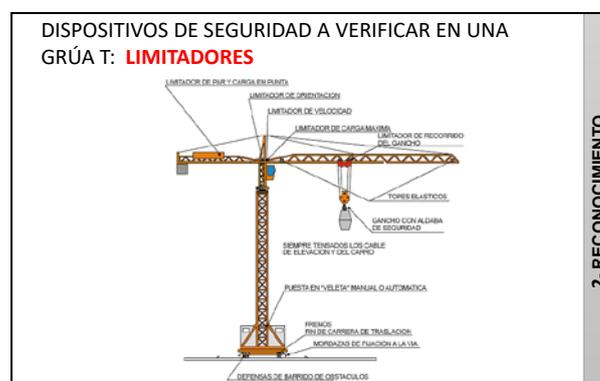
Toda Grúa tiene dispositivos electrónicos que mejoran su seguridad. Limitadores de carrera, relés, motores con potenciómetros, etc. constituyen un complejo sistema de dispositivos electromecánicos que limitan el ángulo de giro, el movimiento del carro, sus velocidades, etc.
