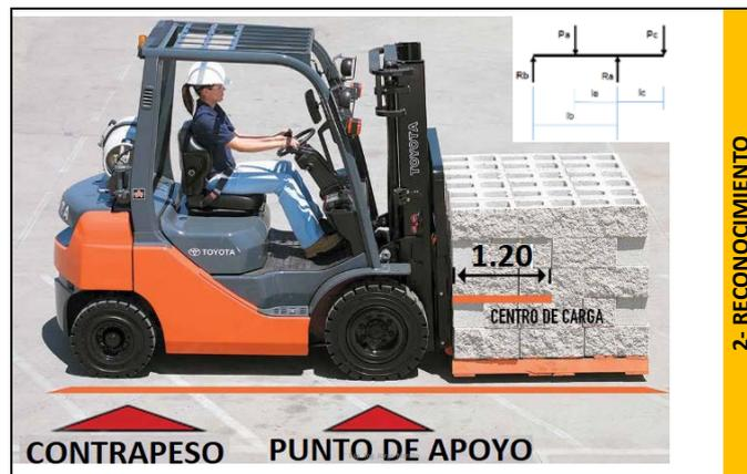
El esquema de cargas para resolver la verificación del vuelco del autoelevador es el de arriba.
