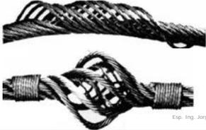
DEFECTO TIPO JAULA PRODUCIDO POR CICLOS ABRUPTOS DE DESCARGA Y CARGA SUCESIVAS
