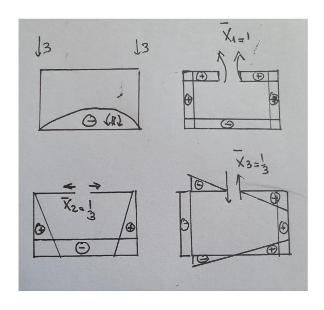
En la figura superior izquierda se muestra el diagrama de momentos debido a la carga distribuida. En la figura superior derecha el diagrama de momentos debido a  $X_1 = 1$  y en las figuras inferiores los diagramas debidos a  $X_2$  y  $X_3$ , respectivamente.
