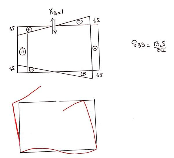
Para calcular los términos de carga se deben calcular los diagramas de momento debidos a las cargas P/2.
