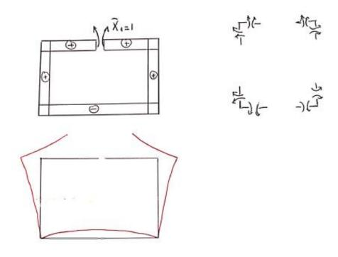
Para calcular las flexibilidades se deben calcular los diagramas de momento debidos a las incógnitas. En este caso se muestran el diagrama de Momentos para  $X_2=1$  y la elástica correspondiente.
