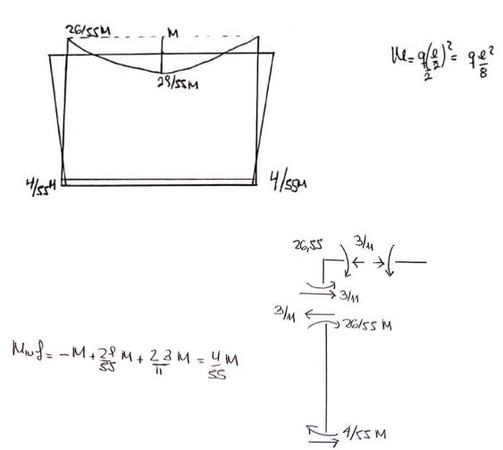
Para calcular las flexibilidades se deben calcular los diagramas de momento debidos a las incógnitas. En este caso se muestran el diagrama de Momentos para  $X_3=1$  y la elástica correspondiente.
