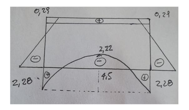
El diagrama de momento final se obtiene, de la misma forma que en los otros ejemplos del Método de las Fuerzas: combinando linealmente los diagramas de momentos en el Sistema Fundamental debidos a las cargas a X<sub>1</sub> y a X<sub>2</sub>. Cabe señalar que se debe multiplicar, para los casos en que se haya escogido una incógnita no unitaria, el diagrama del SF por el valor de la incógnita correspondiente.
