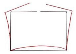
Para calcular los términos de cargas se deben trazar el diagrama de Momento debidos a las cargas exteriores. En este caso se muestran el diagrama de Momentos y la elástica correspondiente.
