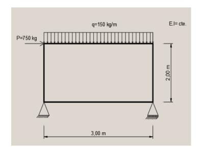
La estructura es un marco cerrado, luego el grado de hiperestaticidad es 3. Posee dos ejes de simetría geométrico, uno vertical y uno horizontal. Hay simetría de vínculos respecto del eje de simetría vertical. La carga repartida uniforme es simétrica. Sin embargo la carga concentrada P no es ni simétrica ni antisimétrica. Hay que descomponer a la carga P en dos estados de carga, uno simétrico, otro antisimétrico.
