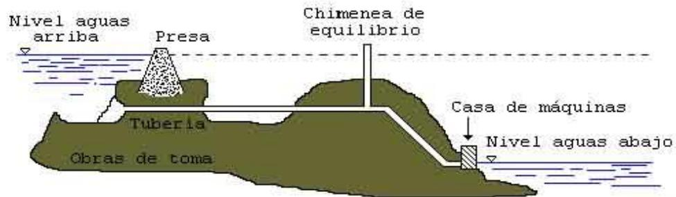
Fig.: 7. Central con derivación. Vista en planta y corte
