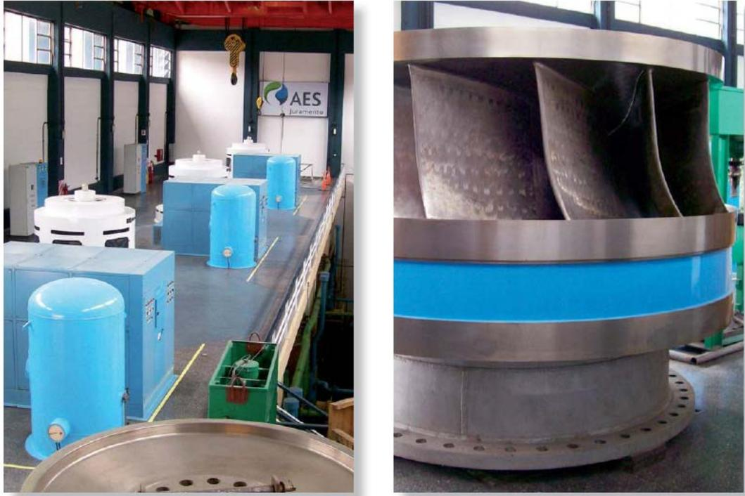
*Figura 32: Vista de la central con los tres grupos generadores de la misma, vista del rotor de una de las turbinas Francis*
