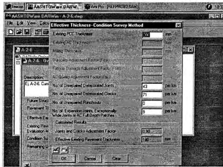
Fig. A.2.6.2. Determinación de espesor efectivo de losa
