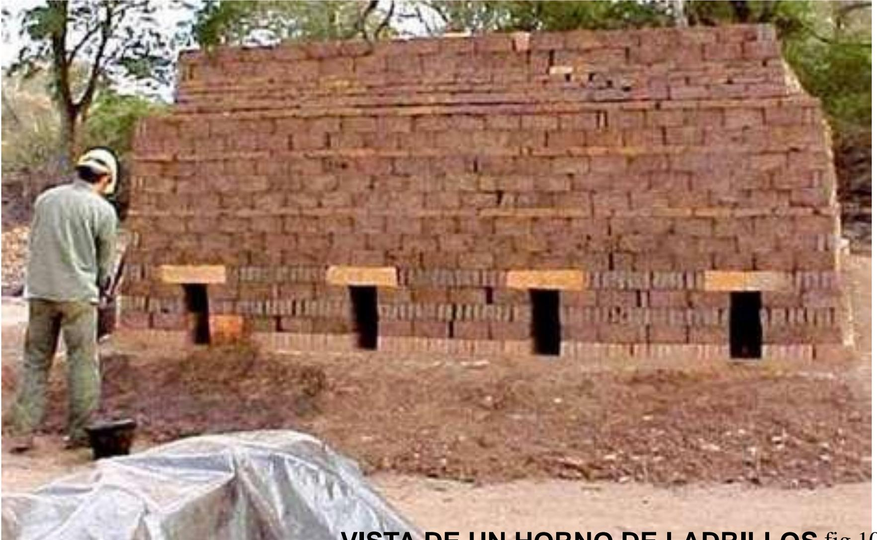
**VISTA DE UN HORNO DE LADRILLOS** fig 10
