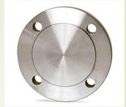
Están destinadas a cerrar extremos de tubería, válvulas o aberturas de recipientes, sometidos a variadas presiones de trabajo. Este tipo de bridas, es el que soporta condiciones de trabajo más severas (particularmente las de mayores dimensiones), ya que, al esfuerzo provocado por la tracción de los bulones, se le adiciona el producido por la presión existente en la tubería.
