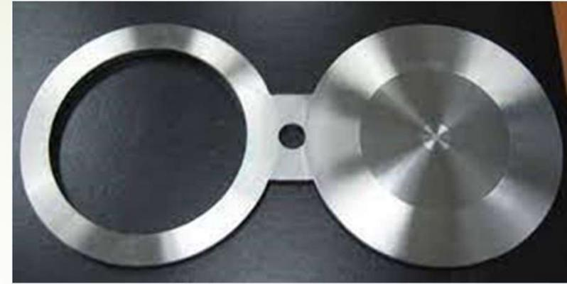
Las figuras 8 son elementos destinados a la obturación de cañerías en las que circulan fluidos. Están diseñados para ir intercalados entre dos bridas con sus correspondientes juntas.
