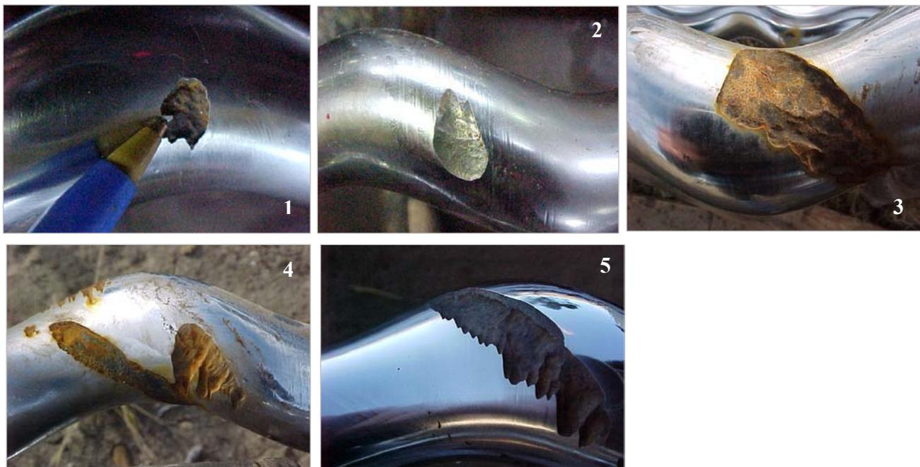
Generalmente esta falla comienza por la degradación del cromo y luego continúa la pérdida de material del material base del rotor ( por corrosión- fotos 1, 2 y 3), o continúa con un desgaste por abrasión del material base ( fotos 4 y 5)
