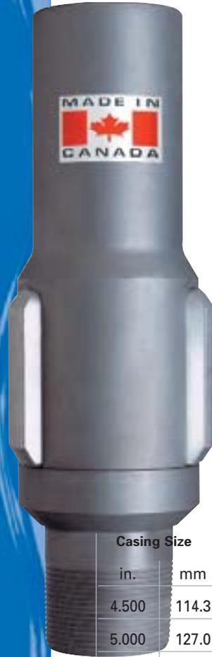
El niple anti-vibratorio de Kudu viene equipado de zapatas de resorte para atenuar los movimientos de la tubería de producción, amortiguar las vibraciones y reducir la resonancia armónica. Con ello se reduce el desgaste de las bombas, de las tuberías, de las sartas de varillas y de las anclas.
