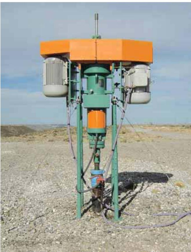
◀ *Cabezal para bombeo por cavidades progresivas.*
