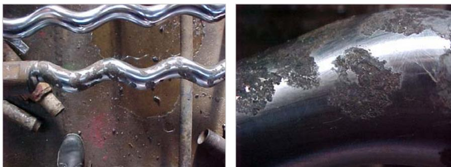
El cromo se desprende en forma localizada sin llegar a afectar el material base. Este desprendimiento se produce generalmente en la parte superior del rotor, en la zona que está fuera del estator (dentro del niple espaciador). Se puede dar por el ataque del fluido al cromo.
