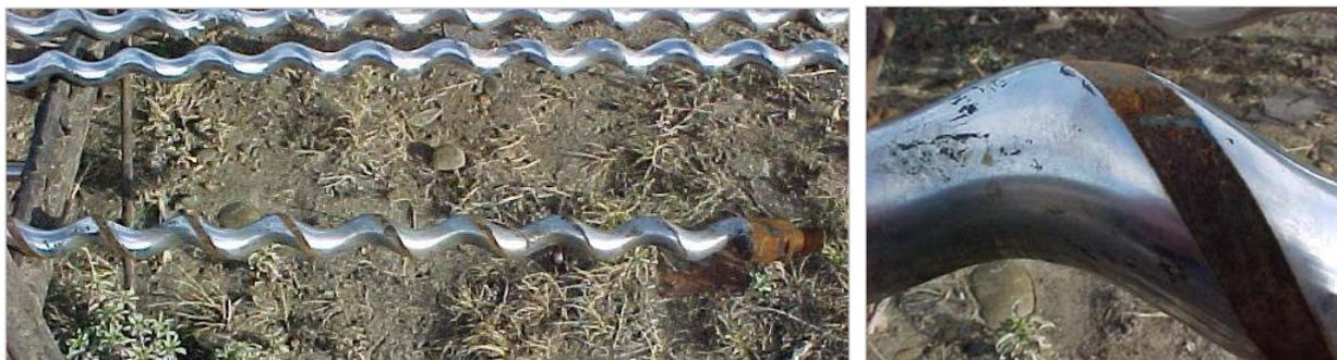
El desgaste se produce generalmente en la parte superior del rotor, en el tramo que queda fuera del estator (rozamiento con el Niple espaciador), o en la parte inferior del rotor, por rozamiento con en nicle de paro.
