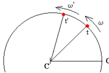
Si un punto sobre un objeto gira desde una posición angular  $\theta_1$  hasta una posición  $\theta_2$ , su desplazamiento angular será:  $\Delta\theta$ . En un lapso de tiempo  $\Delta t$  la velocidad angular media que adquiere
