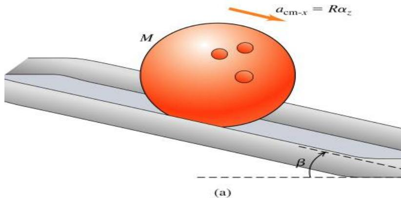
En la dinámica del objeto rodante, se analiza la traslación del CM más la rotación con respecto al CM, considerando la 2<sup>o</sup> ley de Newton:
