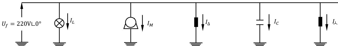
Para las lámparas tenemos:  $I_L = \frac{P}{\sqrt{3} \cdot U_L \cdot \cos \varphi} = \frac{210 \cdot 60W}{\sqrt{3} \cdot 380V \cdot \cos 0^\circ} = 19,1A \angle 0^\circ$
