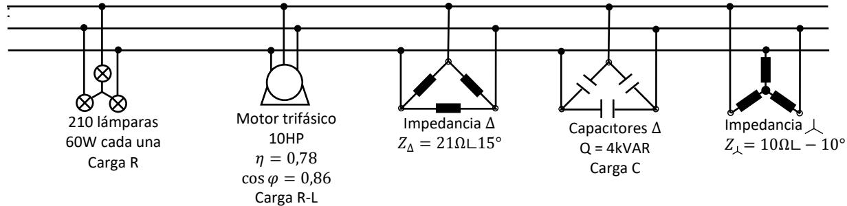
Si resolvemos uno por uno estos sistemas trifásicos, podríamos obtener cada una de las corrientes. Para ello, reducimos cada sistema a estrella, transformando los triángulos en estrella, y trabajamos como si estuviéramos en un sistema monofásico. Entonces:
