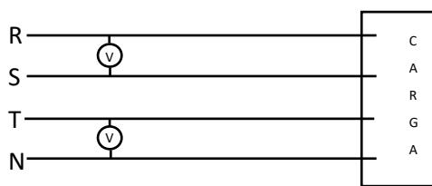
Y llamaremos tensión de línea  $U_{RS}$ ,  $U_{ST}$ ,  $U_{TR}$  a la tensión entre los conductores vivos, y tensión de fase a la tensión que existe entre cada una de ellas y el neutro:
