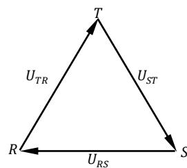
4º- Si se trata de cargas equilibradas, estableceremos entre cada vértice y el centro del triángulo, las tensiones de fase, quedándonos armado el triángulo didáctico, donde rápidamente podemos ubicar los vectores y sus ángulos.
