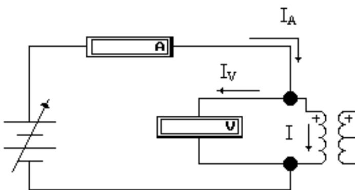
La intensidad de la corriente no debe superar el 15% de la nominal del arrollamiento. Los conductores de unión del voltímetro deben ser independientes de los del circuito serie.
