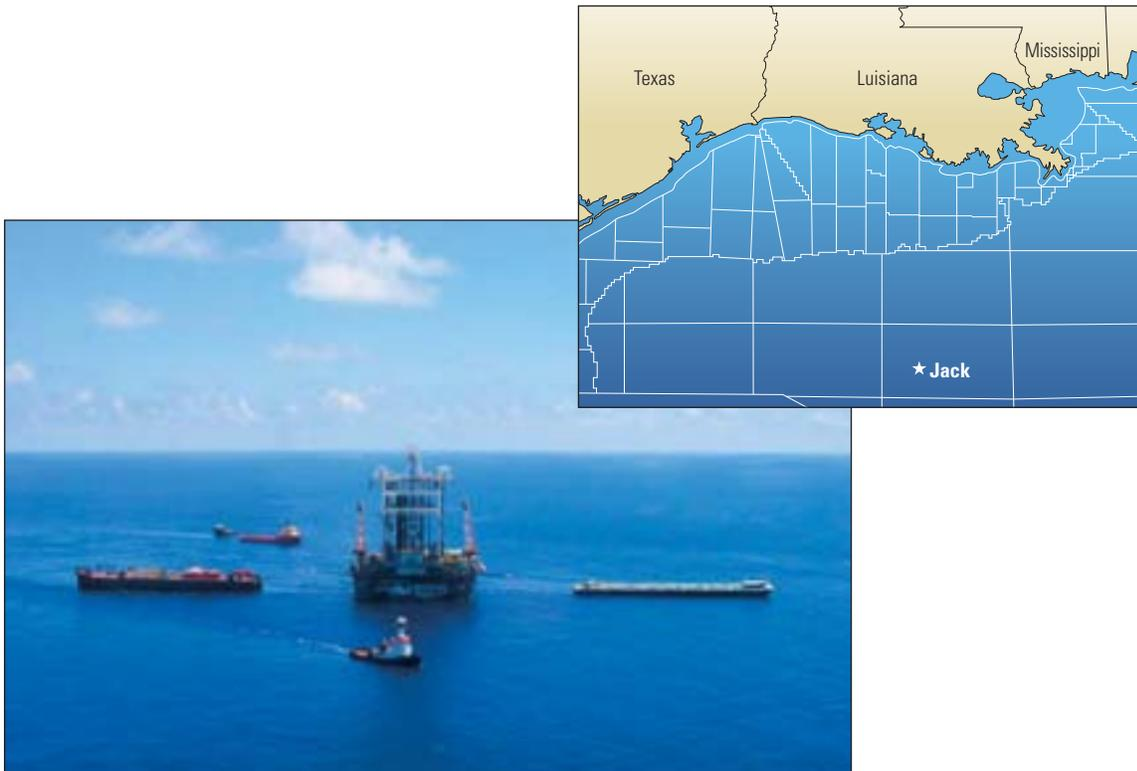
^ Preparación para la prueba. El Pozo Jack 2, perforado con la embarcación de perforación *Discoverer Deep Seas*, fue entubado y suspendido antes de que el equipo de perforación semisumergible *Cajun Express* fuera transportado a la localización del pozo para efectuar una prueba de pozo de largo alcance. También se llevaron barcasas a la localización del pozo para recolectar los fluidos producidos en la prueba.
