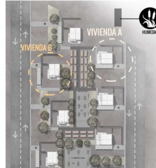
Se realizó un juego en cuanto a la ubicación de aberturas, y la selección de los terrenos, de manera que cada vivienda pueda obtener la cantidad necesaria de iluminación y captación de energía solar térmica.
