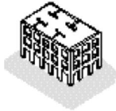
Muros resistentes al cortante en algunos pisos, marcos resistentes al momento en otros
