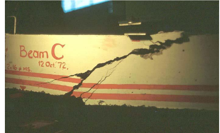
Fig. 6.18 Distintos tipos de fisuras que aparecen en vigas de hormigón armado según ubicación y combinación de esfuerzos
