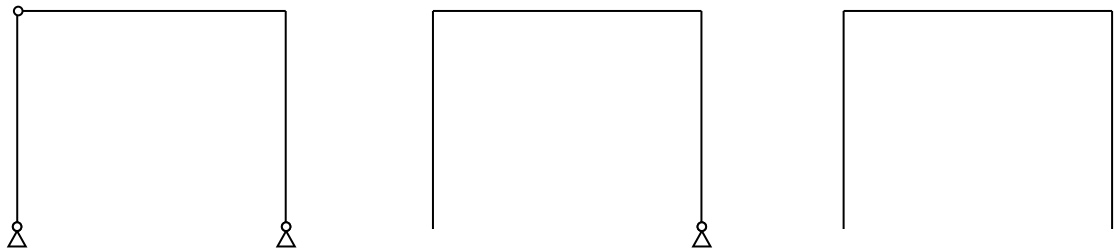
Fig 1. Pórticos. a) isostático; b) hiperestático grado 2; c) hiperestático grado 3
