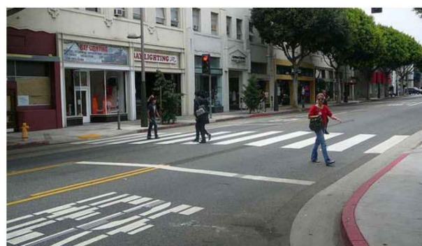
Imag. 4.27 Las líneas de contención o rayas de parada alertan a los vehículos de la presencia de peatones Fuente: Alta Planning, 2010
