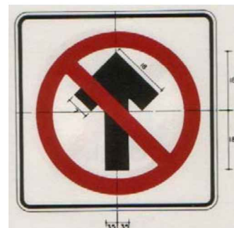
Fig. 4.29 Señal de prohibido seguir de frente
