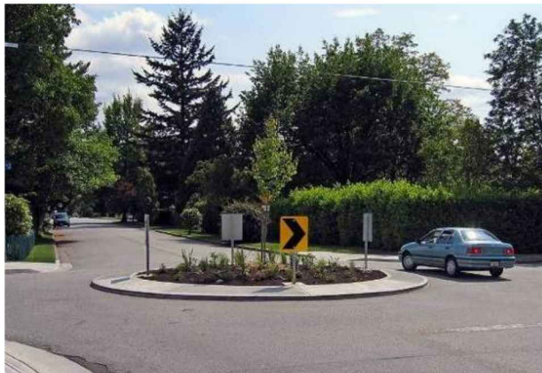
Imag. 5.20 Miniglorieta en intersección
