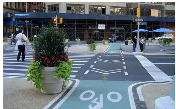
Imag. 4.17 Señalización en cruceo que diferencia el espacio de peatones y de ciclistas
