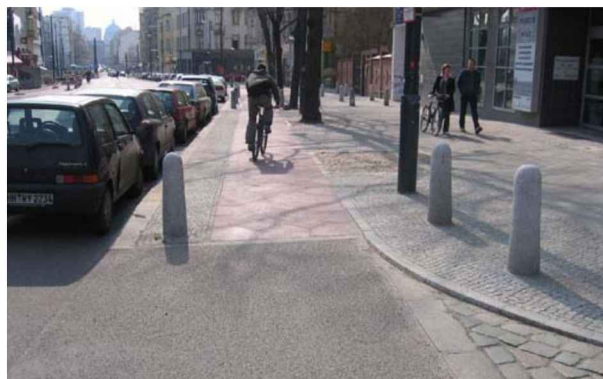
Imag. 5.05 Ciclovía a nivel de banqueta con una clara separación entre el área peatonal y el arroyo vehicular. Berlín, Alemania Foto:www.streetsblog.org
