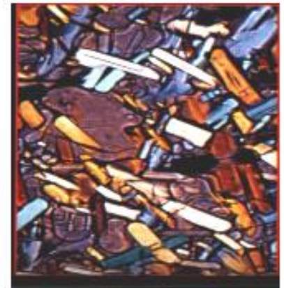
Micrografia óptica de transmisión del nitruro de silicio (Si 3 N 4 ). 750X.
