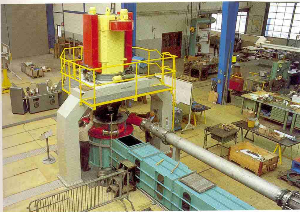
6. Modèle d'essai installé sur le stand Hydro Vevey durant les essais de réception ( B = 90 mm, H = 100 m) (photo Hydro Vevey).
