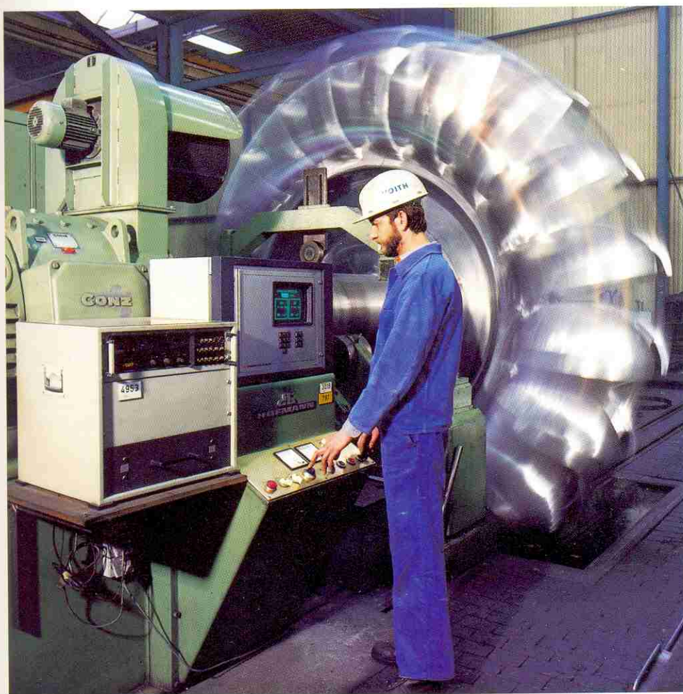
6. Equilibrage dynamique d'une roue (photo Voith).
