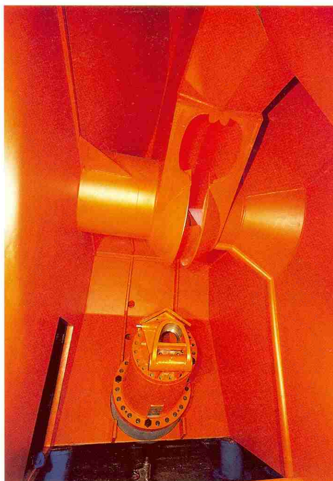
2. Répartiteur et bâti de turbine préassemblés en ateliers (photo Hydroart).
