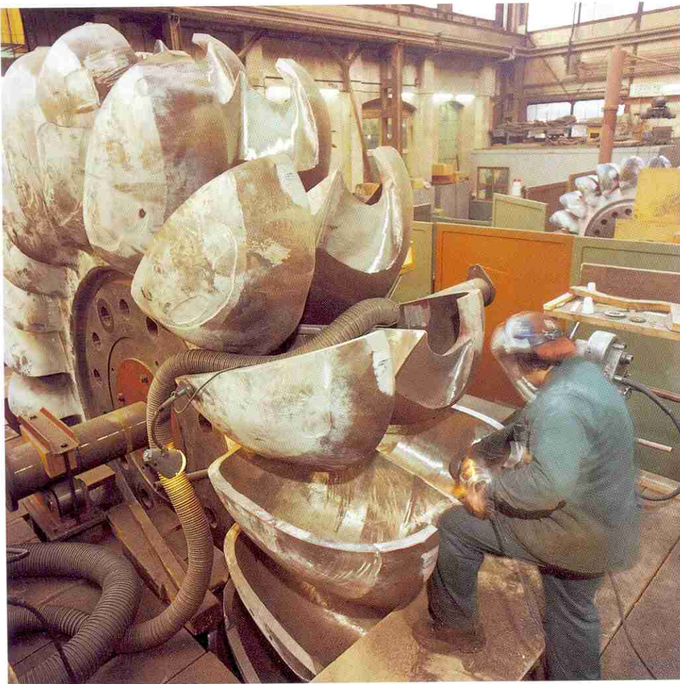
5. Meulage de finition des augets dont on remarque la très grande largeur ( B = 1,110 m) (photo Sulzer-Escher Wyss).
