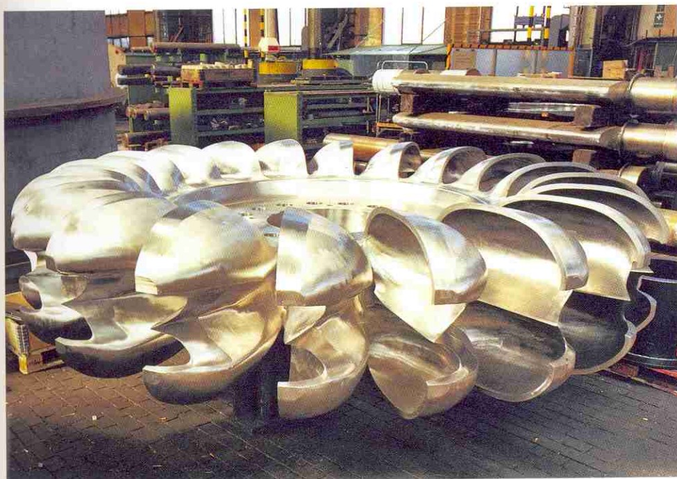
5. Roue en acier inoxydable 13 Cr - 4 Ni d'une masse de 14,2 t et d'un diamètre de 3,600 m (photo Voith).
