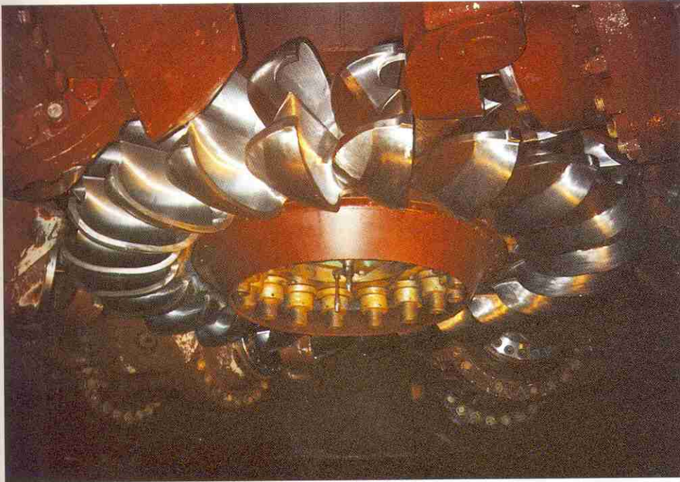
5. Roue en acier inoxydable 13 Cr - 4 Ni d'une masse de 9,8 t (photo Hydro Vevey).
