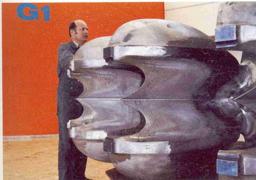
6. Vue du dos des augets. On remarque les échancrures ainsi que les nervures (photo Electricité d'Emosson).
