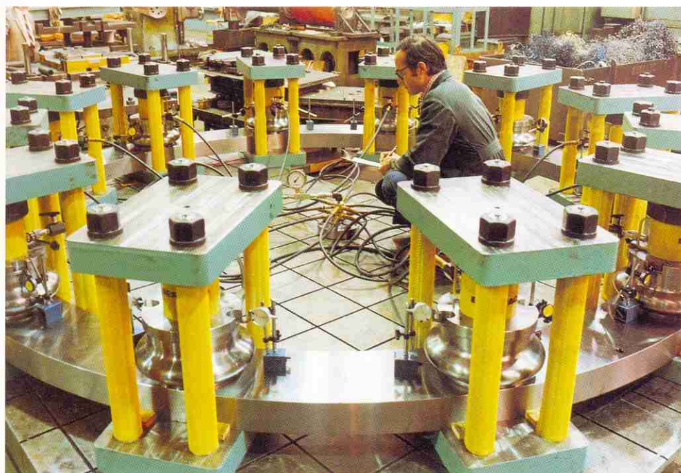
9. Supports des patins de la butée montés sur la couronne d'appui qui transmet les efforts au cône support. Cette couronne renferme les canaux d'huile qui répartissent la pression dans les supports à membranes. Photographie prise durant l'essai de pression (photo MIL Tracy).
