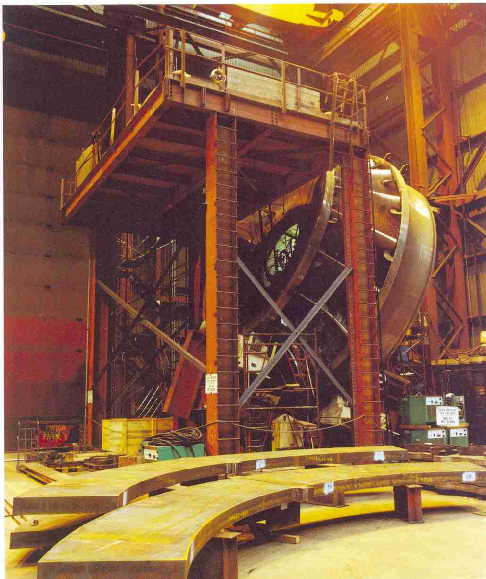
11. Roue en cours de soudure dans le positionneur destiné à assurer la position horizontale du bain de métal liquide. Au premier plan, tôles des flasques de l'avant-distributeur (photo DBS Escher Wyss).
