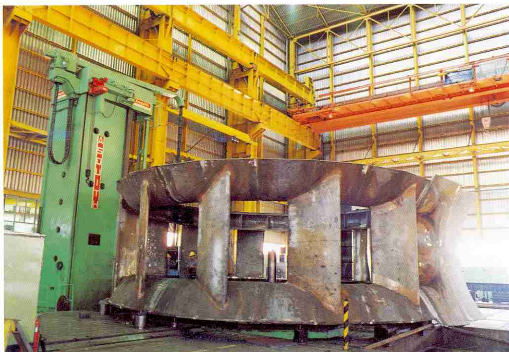
1. Avant-distributeur à double courbure assemblé en usine (photo IMPSA).
