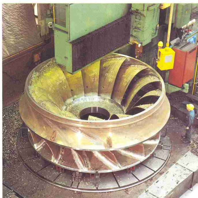
8. Roue en cours de tournage final (photo Sulzer-Escher Wyss).
