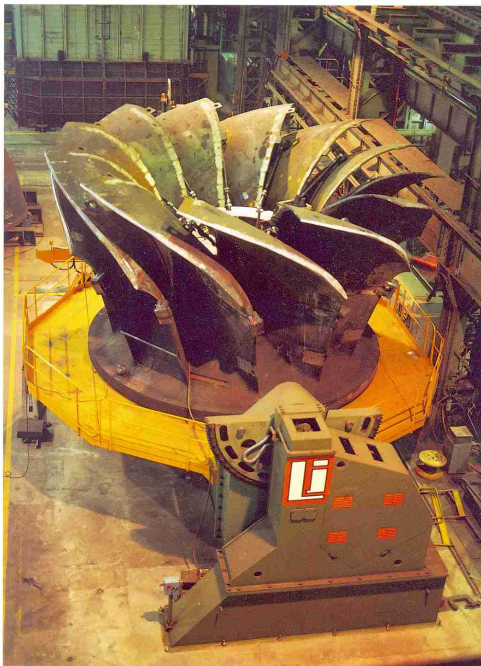
9. Fixation des aubes (photo Neyrpic).
