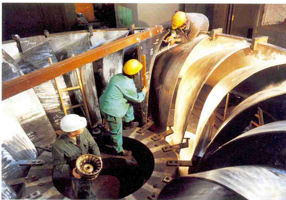
2. Roue à 18 aubes, en phase d'ajustement, avant soudure. On remarque en outre la roue modèle d'un diamètre de 340 mm (photo Voest-Alpine).
