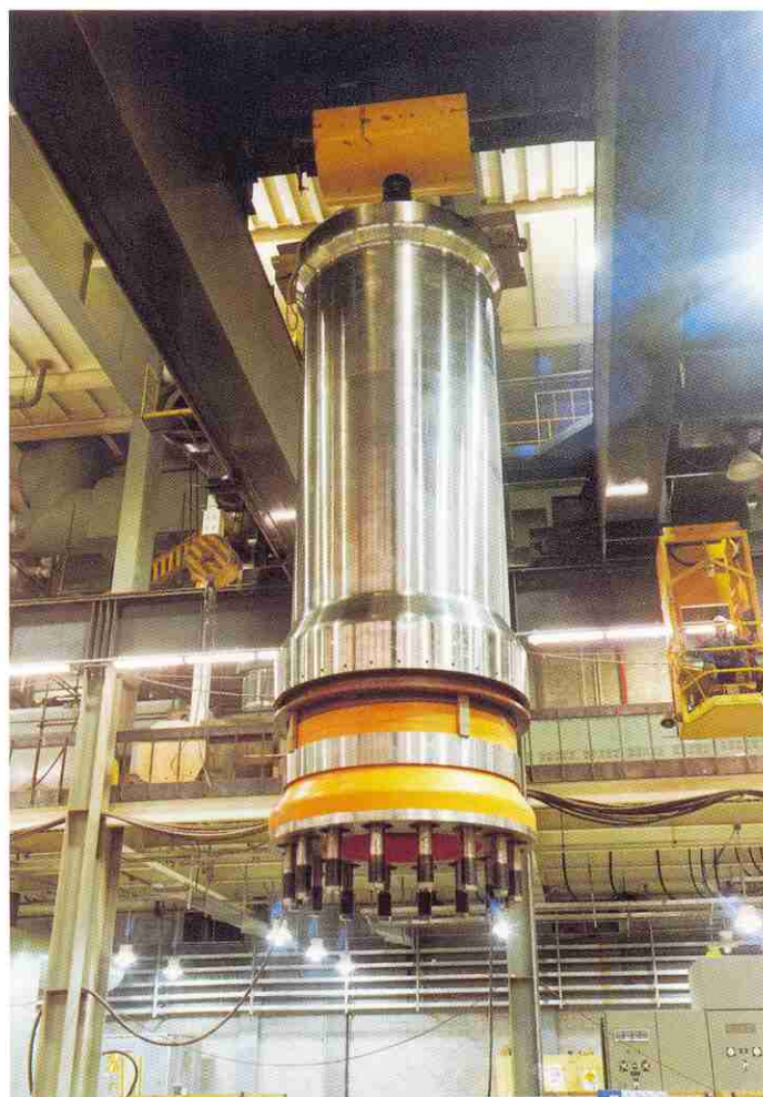
8. Arbre de la turbine. Les boulons d'assemblage sont dans l'axe de la paroi. On remarque la portée usinée pour les joints et la cloche du palier de turbine (photo MIL Tracy).
