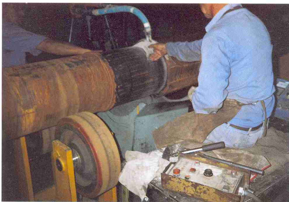
5. Revêtement d'acier inoxydable d'un arbre d'aube directrice (photo IMHEF).
