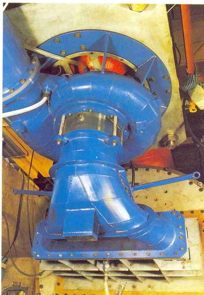
2. Modèle d'essai sur la plate-forme de Voest-Alpine MCE à Linz ( D_{ie} = 348,5 mm) (photo Voest-Alpine).
