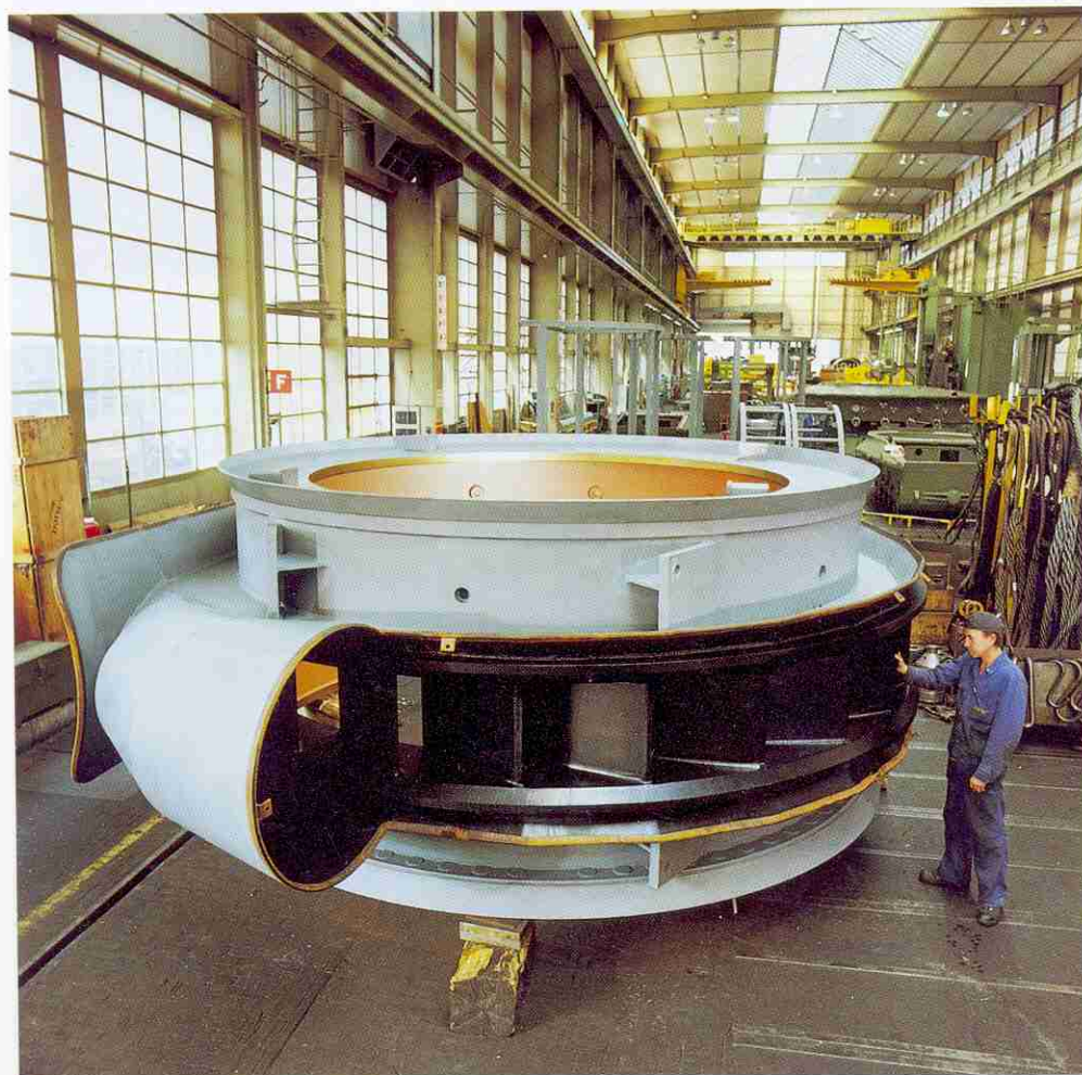
1. Avant-distributeur terminé en ateliers (photo Hydro Vevey).
