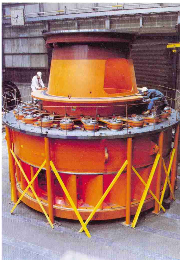
6. Prémontage du distributeur en atelier (photo MIL Tracy).
