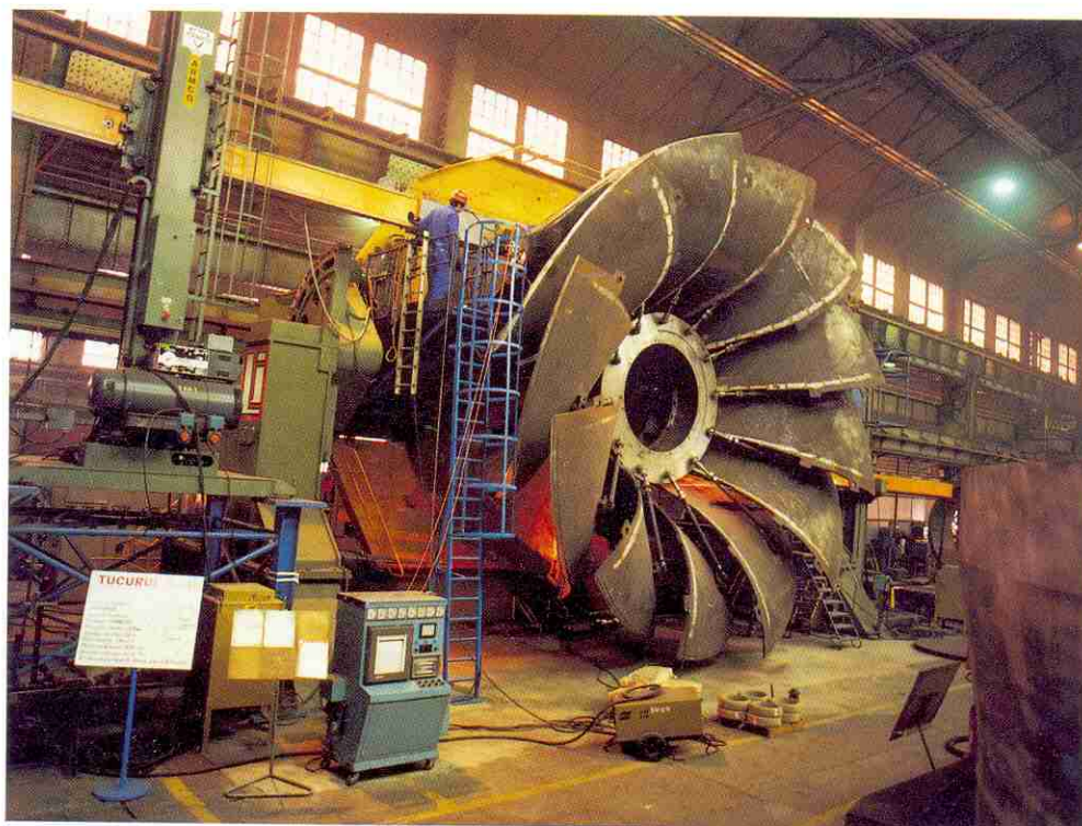
10. Soudure des aubes à l'aide de positionneurs en position de l'axe horizontal (photo Neyrpic).
