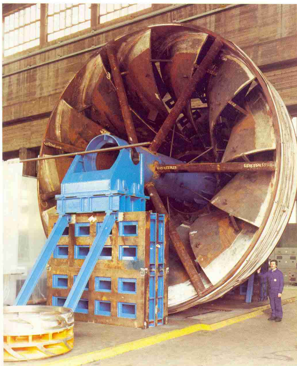
5. Roue complète en cours de soudure dans son positionneur (photo Riva Hydroart).
