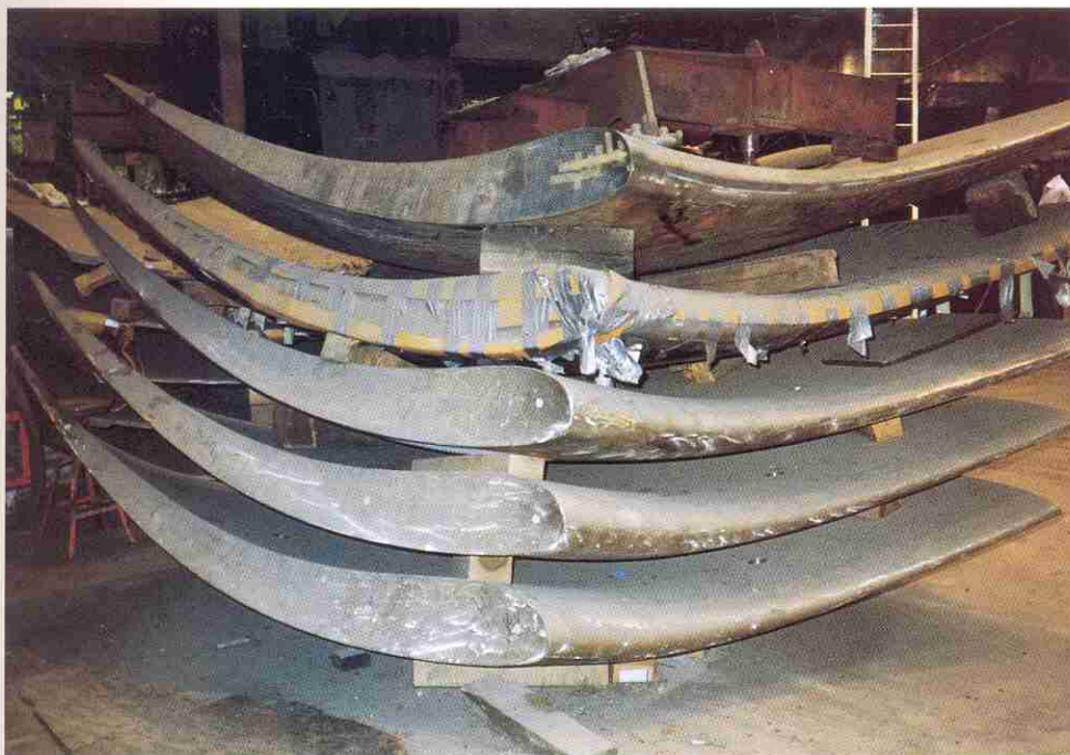
7. Aubes de la roue, usinées par machine à commande numérique, prêtes pour l'assemblage (photo IMHEF).
