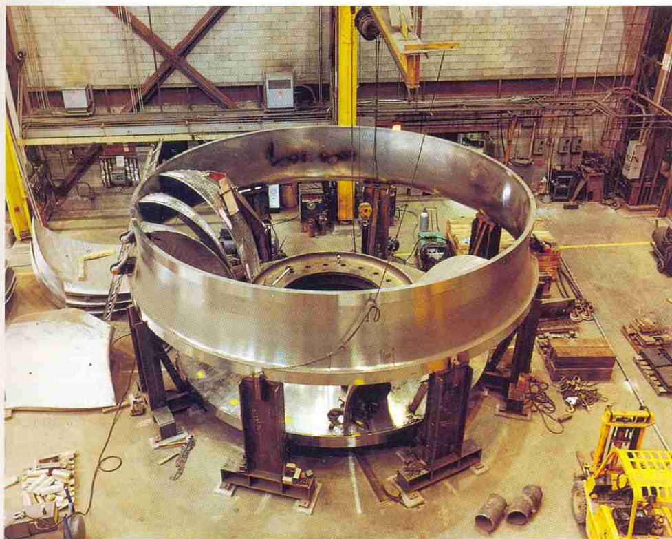
8. Assemblage de la roue et préparation avant soudure (photo DBS Escher Wyss).
