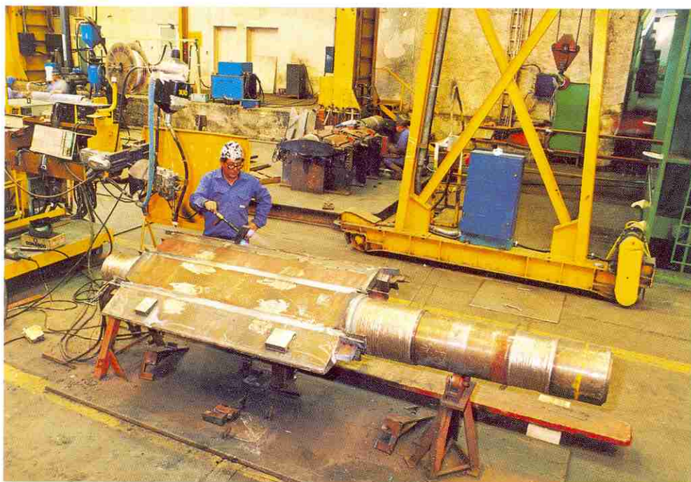
4. Aube du distributeur en cours de soudage (photo IMPSA).
