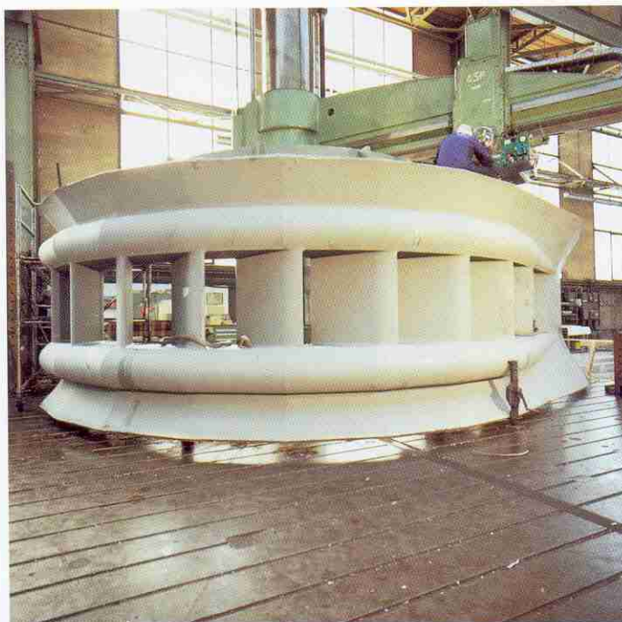
1. Avant-distributeur de type Piguet à bourrelets et avant-directrices planes (photo VOITH).
